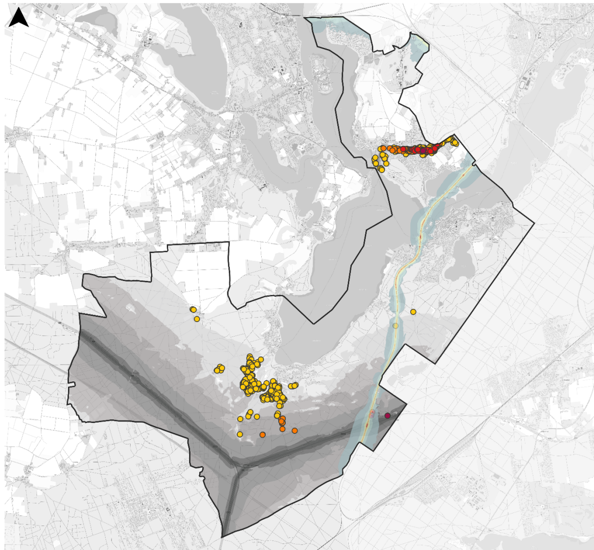
Abbildung 15: Grafische Überlagerung der Isophonen des Straßenverkehrslärms und der Straßenverkehrslärm-bezogenen Immissionspegel der Wohngebäude durch Isophonen des Schienenverkehrslärms (jeweils L Night )
